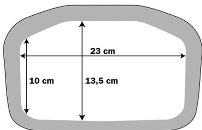
Abmessungen transparentes Deckelfach 5 L Version
